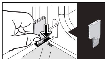
Αφαιρέστε το πρώτο στρεωμένο τζάμι: Χρησιμοποιώντας το άλλο στοπ (ή ένα κατσαβίδι), ασκήστε πίεση στις υποδοχές **A**,
