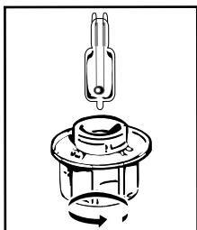
**Du kan själv byta lampa när den inte längre fungerar.** Använd en gummihandske när du ska skruva loss lampglas och lampa så går det lättare. Sätt i den nya lampan och sätt tillbaka lampglaset.
