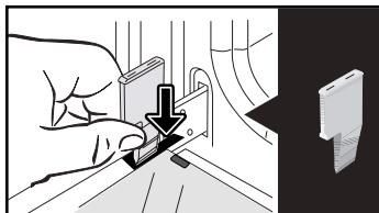
Retire o primeiro vidro: Com a ajuda da outra calha (ou de uma chave de fendas), pressione contra os pontos A para retirar o vidro. Retire o vidro.
