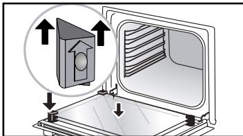
Après nettoyage, repositionnez les quatre butées caoutchouc flèche vers le haut et repositionnez l'ensemble des vitres.
