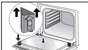
Po vyčištění znova nasaďte 4 pryžové zarážky zelenou šípkou směrem nahoru a skla opět nainstalujte.
