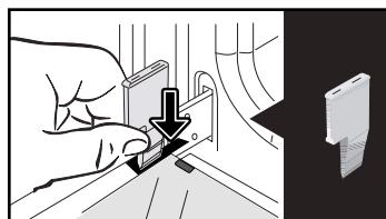
Retirez la première vitre clippée : A l'aide de l'autre cale (ou d'un tournevis) appuyez dans les emplacements A afin de décliquer la
