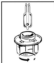
**Вы можете сами заменить лампочку,** т.к. она уже не работает. Для откручивания светильника и лампы используйте резиновую перчатку, которая облегчит процесс демонтажа. Вставьте новую лампочку и поставьте на место светильник.
