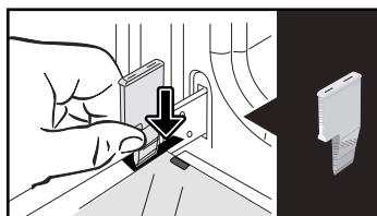
Extraiga el primer cristal enganchado: Con la ayuda de otra cuña (o de un destornillador) presione en las ranuras **A** para desenganchar el cristal. Retire el
