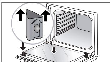
Efter rengøringen skal de fire gummistoppere placeres igen med pilen pegende opad, og glasruderne skal placeres igen.
