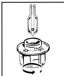
**Voit vaihtaa toimimattoman lampun itse.** Kierrä suojalasi irti ja irrota valo (käytä kumikäsineettä helpottamaan valon suojalasin irrottamista). Aseta uusi valo paikalleen ja suojalasi paikalleen.
