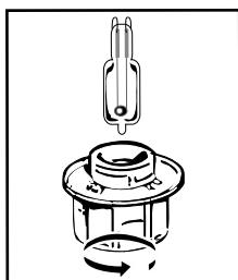
**Pode substituir a lâmpada sem ajuda quando deixar de funcionar.** Para desmontar o difusor luminoso e a lâmpada, utilize uma luva de borracha para facilitar a desmontagem. Insira a lâmpada nova e substitua o difusor.
