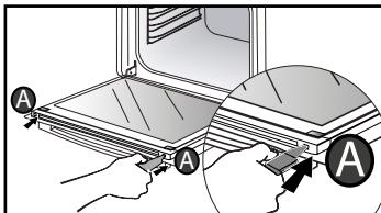
entfernen. Entfernen Sie die Scheibe. Die Tür besteht aus zwei zusätzlichen Scheiben mit einem schwarzen Abstandsbolzen aus Gummi an jeder Ecke.
