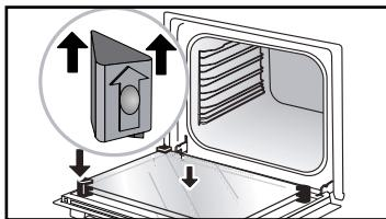
Puhdistuksen jälkeen aseta neljä kumista välijalkaa takaisin paikoilleen kulmiin siten, että nuolimerkintä tulee ylöspäin ja asenna lasikokonaisuus takaisin paikalleen.
