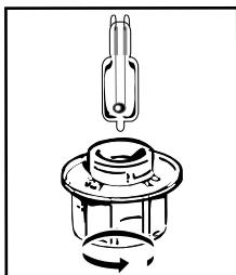
Kiedy lampka nie działa, może zostać wymieniona przez użytkownika. Odkręcić szybę i wyjąć lampkę (należy używać gumowych rękawic - ułatwi to przeprowadzenie demontażu). Włożyć nową lampkę i założyć szybę.
