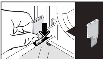
Zdjąć pierwszą szybę zamocowaną na klips: Używając drugiego klinu (lub śrubokręta), nacisnąć w odpowiednich miejscach A, aby zwolnić zaczep szyby.
