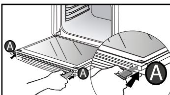
чтобы отщелкнуть стекло. Снимите стекло. Дверца состоит из двух дополнительных стекол, на каждом углу которых находится по черной резиновой соединительной стойке.
