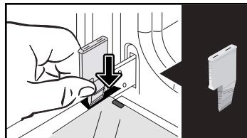
Scheibe: Drücken Sie mithilfe des anderen Keils (oder eines Schraubendrehers) gegen die Einbaupositionen A, um die mit Clip befestigte Scheibe zu
