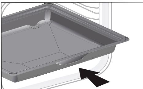
**-Bakplåt, 8 mm.** Skjuts in i ugnsstegarna eller fästs på teleskopkenorna. Denna plåt är perfekt för att baka bröd och bakverk som mördegskakor, cookies, maränger, croissanter m.m. Tack vare den lutande ytan är det lätt att tömma plåten.
