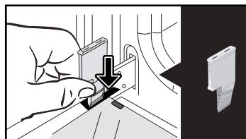
Ta bort den första fastclipsade glasrutan: Använd den andra kilen (eller en skruvmejsel) för att trycka i infattningarna **A** och clipsa loss glasrutan. Ta ut
