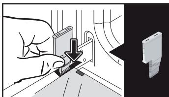
Извлеките первое закрепленное стекло: С помощью другого клина (или отвертки) нажмите на места закрепления **A**, чтобы отщелкнуть стекло.
