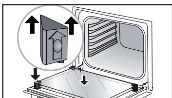
Po zakończeniu czyszczenia należy ponownie założyć cztery gumowe ograniczniki ze strzałką skierowaną do góry i zamontować wszystkie szyby.
