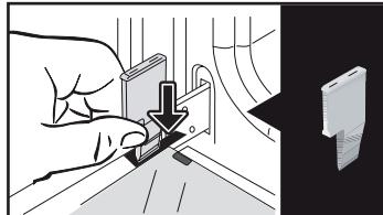
Ta bort den första fastclipsade glasrutan: Använd den andra kilen (eller en skruvmejsel) för att trycka i infattningarna **A** och clipsa loss glasrutan.
