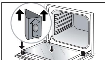
Po vyčištění znova nasadte 4 pryžové zarážky zelenou šipkou směrem nahoru a skla opět nainstalujte.
