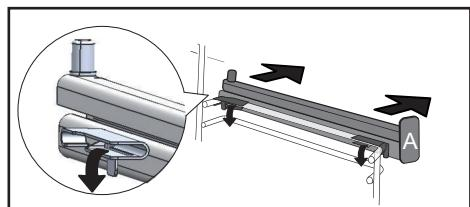
**NOTA:** despliegue la parte deslizante telescópica de la guía hacia la parte delantera del horno con el tope **(A)** orientado hacia usted.
