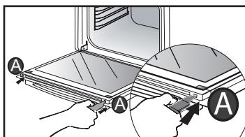
Fjern ruden; Lågen består af to supplerende glasruder med et sort gummi mellemstykke i hvert hjørne.
