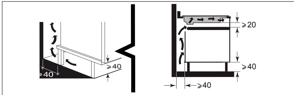
o de un horno empotable, respete las dimensiones indicadas en las imágenes para garantizar una salida de aire suficiente. Pegue la junta de estanqueidad por todo el contorno de vidrio de la placa antes de proceder al empotramiento.
