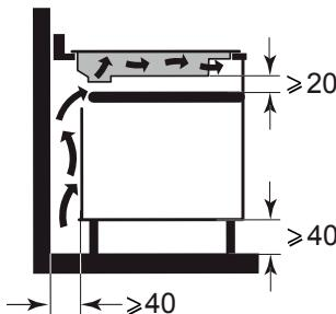
lub piekarnikiem przeznaczonym do zabudowy należy przestrzegać wymiarów wskazanych na ilustracjach, aby zapewnić niezbędny przepływ powietrza wylotowego. Starannie przykleić uszczelkę na całym obwodzie szyby płyty przed zabudową.
