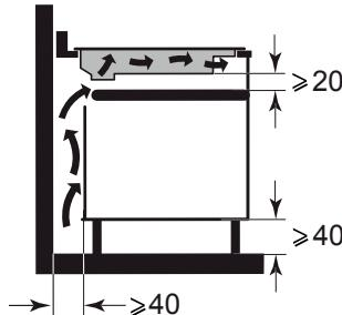
oder über einem einbaubaren Backofen die auf den Abbildungen angegebenen Abmessungen einhalten, damit die Luft gut ausströmen kann.
