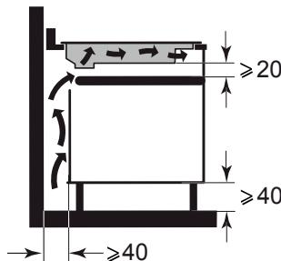
vagy beépített sütő fölé szereltük be, a megfelelő légáramlás biztosítása érdekében tartsuk be az ábrákon feltüntetett méreteket. Beépítés előtt óvatosan ragasszuk fel a tömítőgumit a kerámiafelület teljes kerületén.
