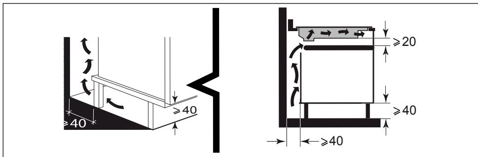
of boven een ingebouwde oven wordt geïnstalleerd, respecteer dan de op de afbeeldingen vermelde afmetingen om zeker te zijn van een voldoende luchtafvoer.
