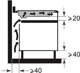
або над убудованою духовою шафою зважайте на розміри, показані на рисунках, щоб гарантувати належний вихід повітря. Перед убудуванням ретельно проклеїте ущільнювач уздовж усього периметра скляної поверхні
