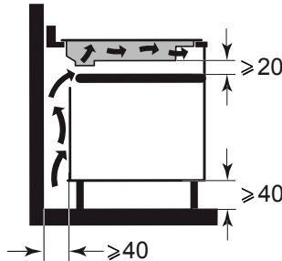
ou por cima de um forno encastrável, respeite as dimensões anotadas nas ilustrações para assegurar uma saída de ar suficiente na parte da frente.
