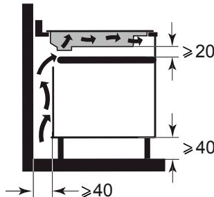
o di un forno a incasso, rispettare le dimensioni indicate sulle illustrazioni al fine di assicurare un'uscita d'aria sufficiente. Incollare con cura la guarnizione di tenuta stagna su tutto il bordo del piano prima dell'incasso.
